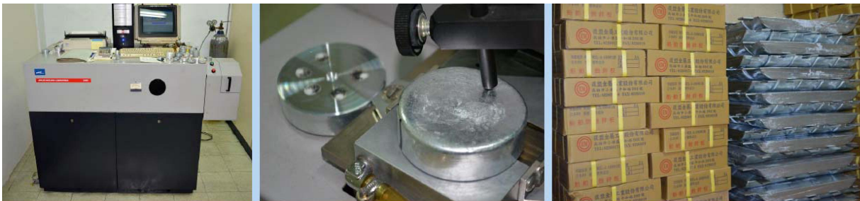
Fisons ARL 3460 Optical Emission Spectrometer 分光儀 本公司產品皆經過分光儀成份分析合格方可生產
